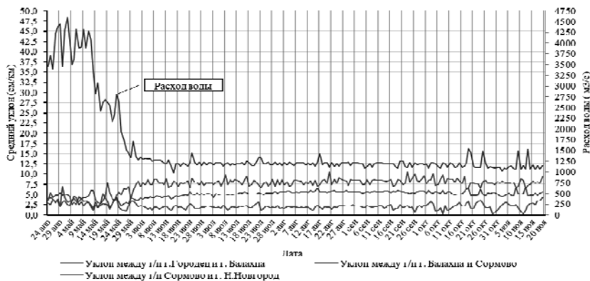
Рис. 5. Совмещенные хронологические графики изменения среднесуточных значений сбросных расходов воды в нижнем бьефе Нижегородского гидроузла и средних значений уклонов свободной поверхности на участках: Городец-Балахна, Балахна-Сормово и Сормово-Нижний Новгород в течение навигации 2018 г.
