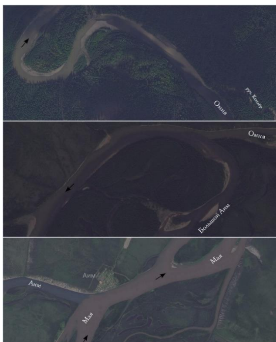
Рисунок 16 — Образование шлейфа мутности и области слияния, образующиеся вдоль смоделированного потока
