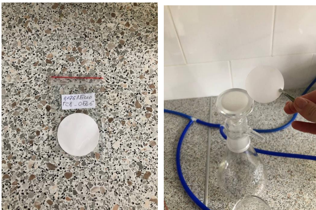
Рисунок 6. Хранение фильтра перед фильтрацией и укладка фильтра на фильтродержатель
