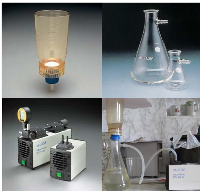
Рисунок 4. Вакуумная фильтровальная система (мерный стакан на фильтродержателе; вакуумный насос; приемная колба; общий вид установки)
